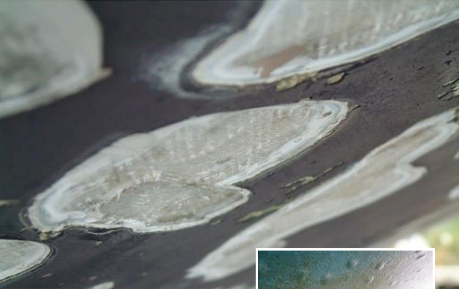
In alto alcune le tracce lasciate da bolle di osmosi rotte. Di lato, unoscafo con delle bolle di osmosi
