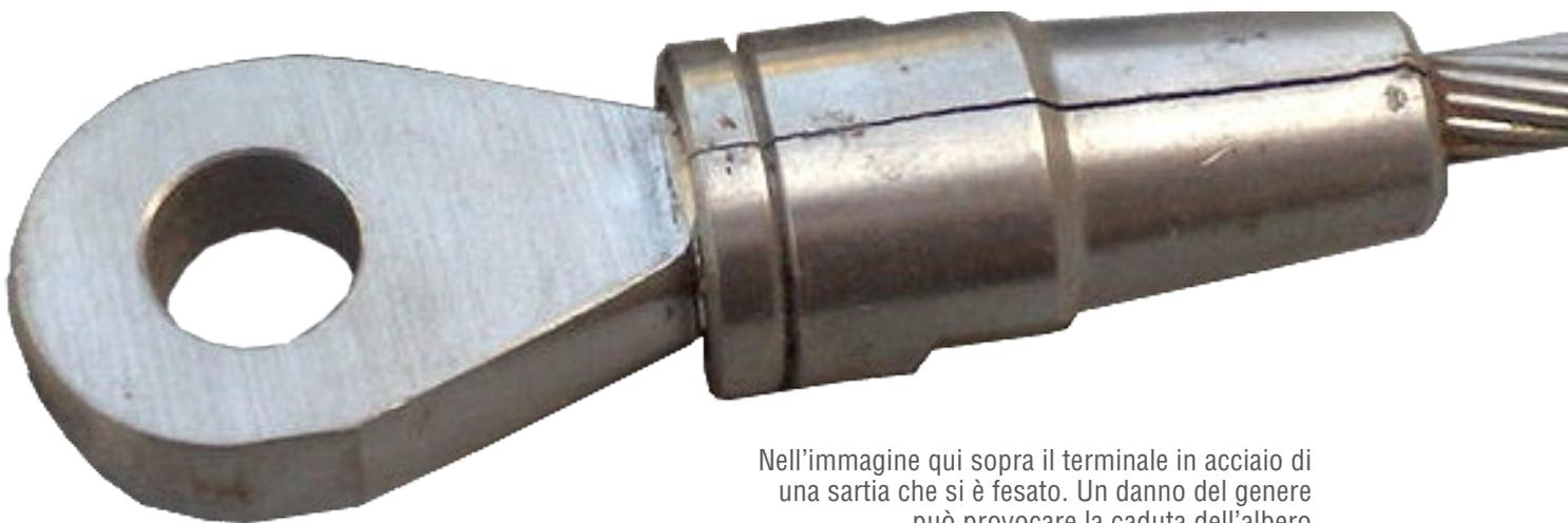
Nell'immagine qui sopra il terminale in acciaio di una sartia che si è fessato. Un danno del genere può provocare la caduta dell'albero
