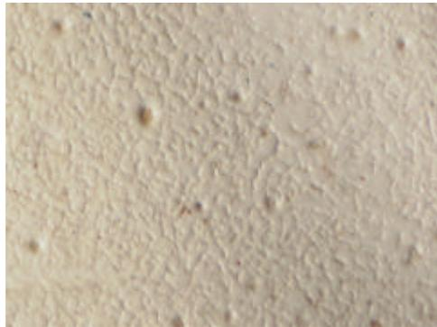
Superficie di un laminato in VTR (ingrandita 32x) che presenta fori a testa di spillo nella superficie pigmentata del gelcoat.
