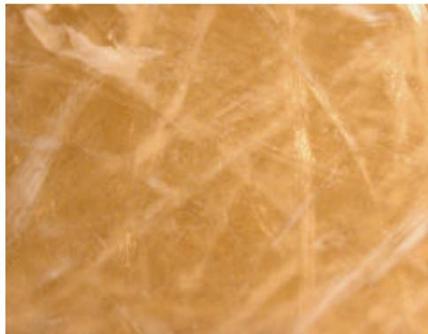
Superficie (ingrandita 32x) di un laminato in VTR che mostra fibre sporgenti
