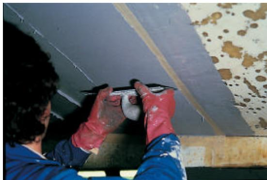
**(Nota:** Quando si lavora ad una temperatura compresa fra i 10 e i 15°C è consigliabile usare la versione di **Interfill 830** con catalizzatore veloce (**YAA867/YAA869**) in alternativa a quello standard. Per ulteriori informazioni consultare la scheda tecnica del prodotto)
